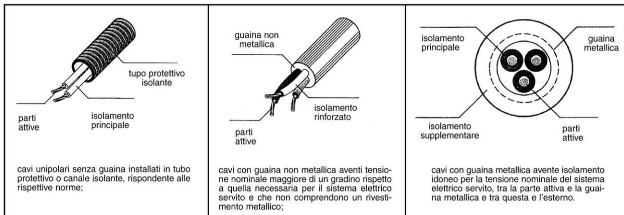
FIG. 6 - Cavi a doppio isolamento. Tipologie
